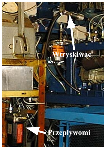
Rys. 7. Układ pomiaru przepływu paliwa Fig 7. Fuel flow measurement system
